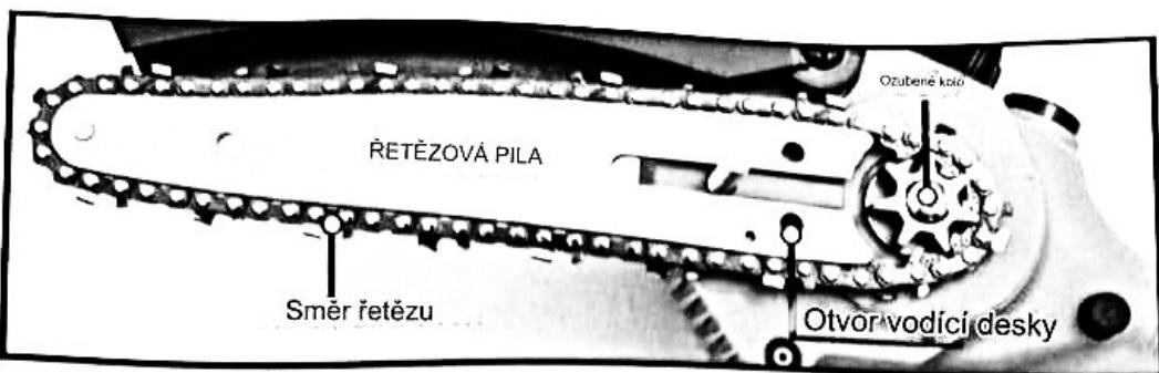
Pokud nelze otvor vodicí desky zasunout do těla pily, rádně jej zašroubujte, nejprve odstraňte řetěz pily a vodicí lištu z těla pily.
